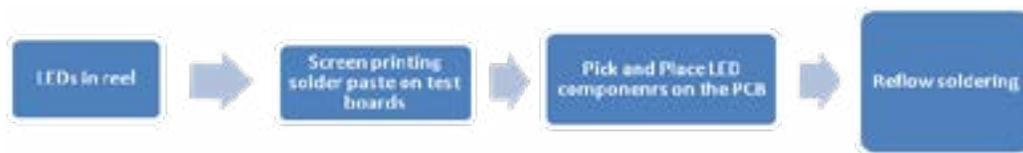
图 3: SMT 工艺流程图
